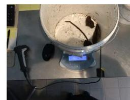
Der Plastikeimer, in dem die Fraktion „Mittelgroß“ der Laborprobe gesammelt wurde, wird gewogen und das Gewicht als „Mittelgroß“ registriert.
