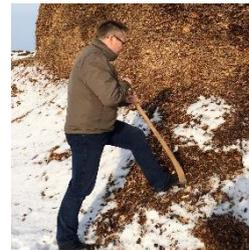
Die Proben werden auf einem gereinigten Untergrund so lange mit der Schaufel gemischt, bis eine homogene Masse entsteht, und dann zu einem Kegel aufgeschichtet. An unterschiedlichen Stellen der gemischten Probe wird mit einem 10-Liter-Plastikeimer mit Deckel eine Laborprobe genommen.
