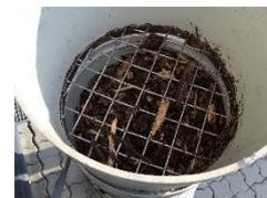
Das Sieb „Extra groß“ wird entfernt und das Sieb „Mittelgroß“ wird so lange geschüttelt (gedreht), bis die Größe „Klein“ aussortiert ist.
